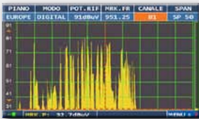
FIG. 1 Misura potenza Ricezione nella banda da 935 MHz a 960 MHz
