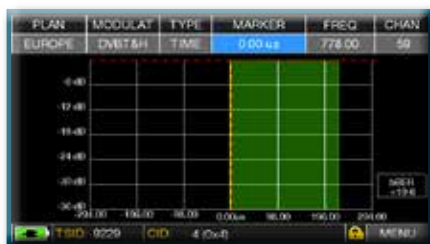
Fig. 1: OTTIMA RICEZIONE: * nessun ECO presente né all'interno né all'esterno della nostra maschera dell'Intervallo di Guardia (area verde).
