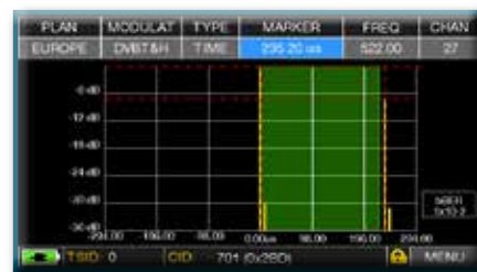
Fig. 3: RICEZIONE MARGINALE (o IMPOSSIBILE):* 2 ECHI presenti all'esterno della maschera dell' Intervallo di Guardia, provenienti da una distanza di: 1° eco: 70,56 Km, pari ad un ritardo di 232,20 \mu s .
