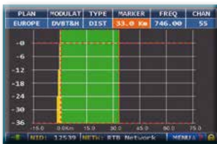
Fig. 1: OTTIMA RICEZIONE: * nessun ECO presente né all'interno né all'esterno della nostra maschera dell'Intervallo di Guardia (area verde).
