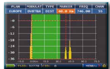
Fig. 3: RICEZIONE MARGINALE (o IMPOSSIBILE): * 2 ECHI presenti all'esterno della maschera dell'Intervallo di Guardia, provenienti da una distanza di: 1° eco: 40 Km, pari ad un ritardo di 133 \mu s . 2° eco: 45 Km, pari ad un ritardo di 150 \mu s .
