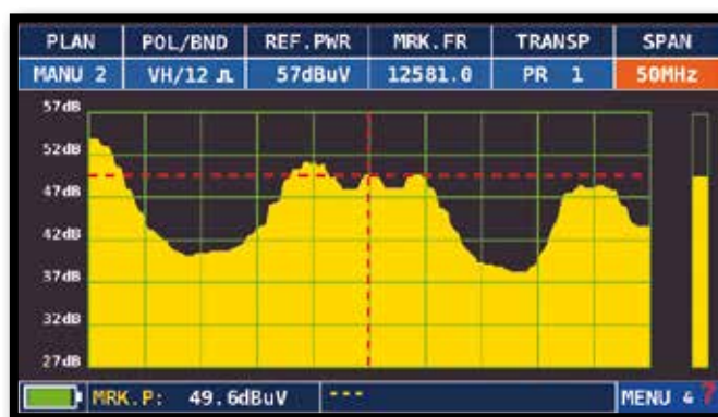
Visualizzazione di un transponder SCPC Con impostazioni: "RBW FILTER 5 MHz" e "dB DIV 5dB" (Span 50 MHz)
