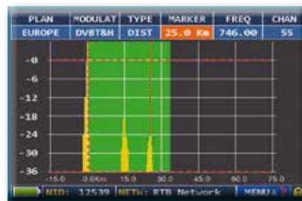
Fig. 2: BUONA RICEZIONE: * 2 ECHI presenti, ma all'interno della maschera nell'Intervallo di Guardia, provenienti da una distanza di: 1° eco: 15 Km, pari ad un ritardo di 50 \mu s . 2° eco: 25 Km, pari ad un ritardo di 83 \mu s .
