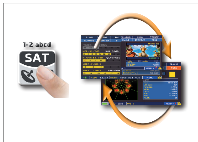
Premi ripetutamente per navigare fra le schermate delle misure SAT
