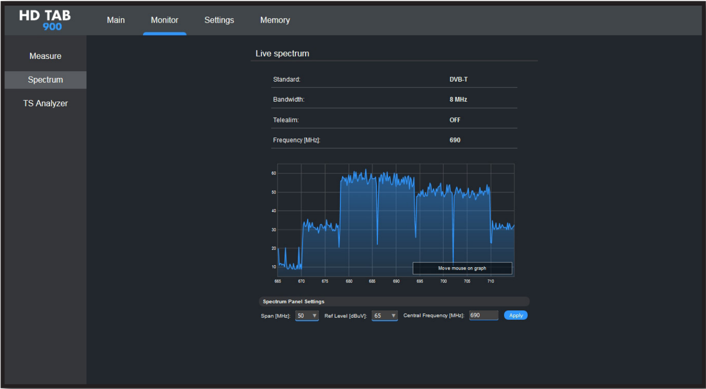
Esempio di VISUALIZZAZIONE di uno SPETTRO TV, SPAN 50 MHz
