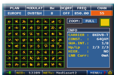
Fig. 4: COSTELLAZIONE DVB-T-64QAM: a destra sono disponibili tutti i parametri di modulazione ricevuti.
