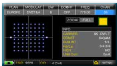
Fig. 4: COSTELLAZIONE DVB-T-64QAM: a destra sono disponibili tutti i parametri di modulazione ricevuti.
